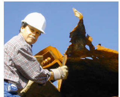
John Gross, der NIST bei der FEMA Building Performance Study vertritt, posiert mit dem erodierten sulfidierten Stahl. NIST behauptete später, dass kein identifizierbarer Stahl von WTC 7 geborgen wurde, und John Gross leugnete die Existenz geschmolzenen Metalls.
