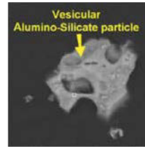
Eine elektronenmikroskopische Aufnahme mit EDS (Energy-Dispersive X-ray Spectroscopy) eines blasigen Aluminiumsilikats, erstellt von RJ Lee.
